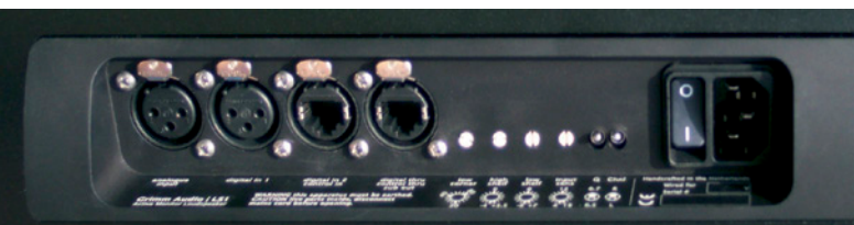
Das im Lautsprecherstativ angebrachte Anschlusspanel des LS1
